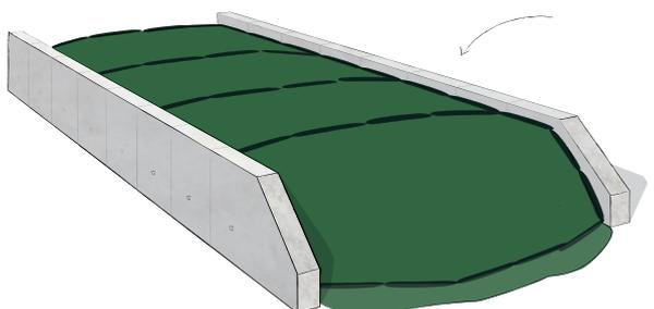
Wir bieten für jeden Betriebsart und Verwendung die passende Silofolie.\* Beschweren Sie die Siloabdeckung an allen Seiten und in regelmäßigen Querabständen mit Sandsäcken, um Luftkanäle zu unterbinden. Siloschutzgitter bieten zusätzlichen Schutz beim Öffnen und vor Tieren.
