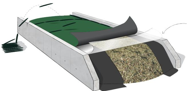
Der ergänzende Einsatz einer Triotech-Unterziehfolie ermöglicht eine schnellere und vor allem sichere Konservierung. Die Auslegung kann mit unseren Silofolienabroller in einem Arbeitsgang zusammen mit der Silofolie erfolgen.
